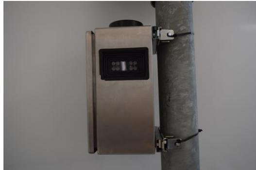
ANPR peut, entre autres, être monté à un poteau d'éclairage existant où on utilise l'alimentation secteur existante. Grâce à cette disposition tous les coûts d'infrastructure (poteau, terrassement, réseau électrique, etc.) sont éliminés. Cette disposition offre d'énormes avantages en termes de prix et de mobilité de l'armoire.
