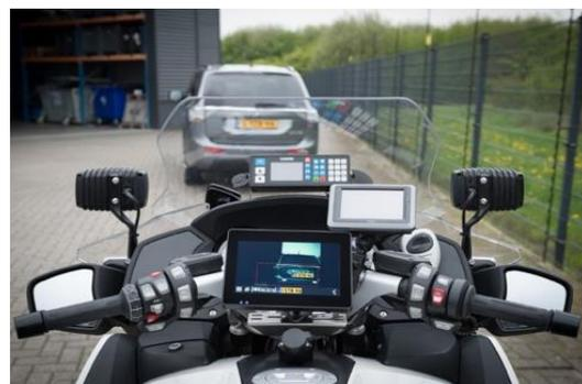
Un système ANPR sur une moto nécessite une version spéciale car la caméra et le moniteur doivent être montés à l'extérieur, où les conditions peuvent être parfois très extrêmes (vibrations, chaleur du moteur, pluie, ...).
