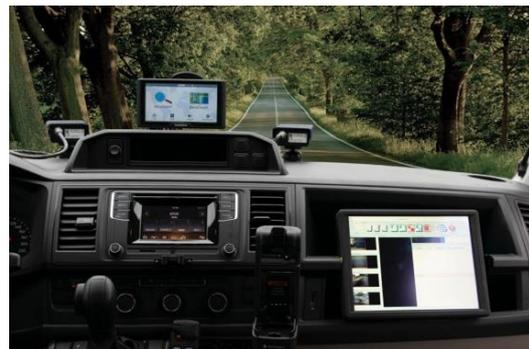
Pour une installation fixe dans un véhicule, on utilise généralement une caméra sur le tableau de bord placée derrière le pare-brise. Les plaques d'immatriculation des véhicules qui passent sont lues à l'aide d'un puissant éclairage à infrarouge. Ce concept unique présente de nombreux avantages pour les utilisateurs: aucun problème de pollution, montage en toute sécurité et vue dégagée pour les utilisateurs.
